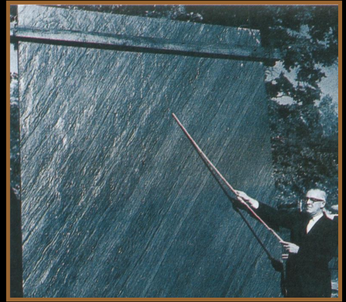
(b) Virginia'da Albemarle Kayrak Ocağından getirilen bu Arvonja kayrak paneli, kayrak dilinimiyle belirli bir açı yapacak şekilde (sağ üstten sol alta doğru) tabakalanma gösterir.
