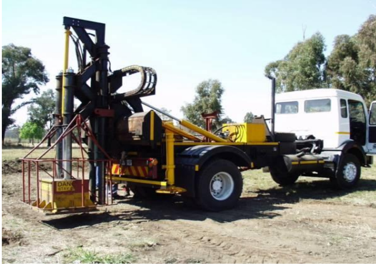
Şekil 29. Mini Dinamik Kompaktör aracı ( http://www.landpac.com )
