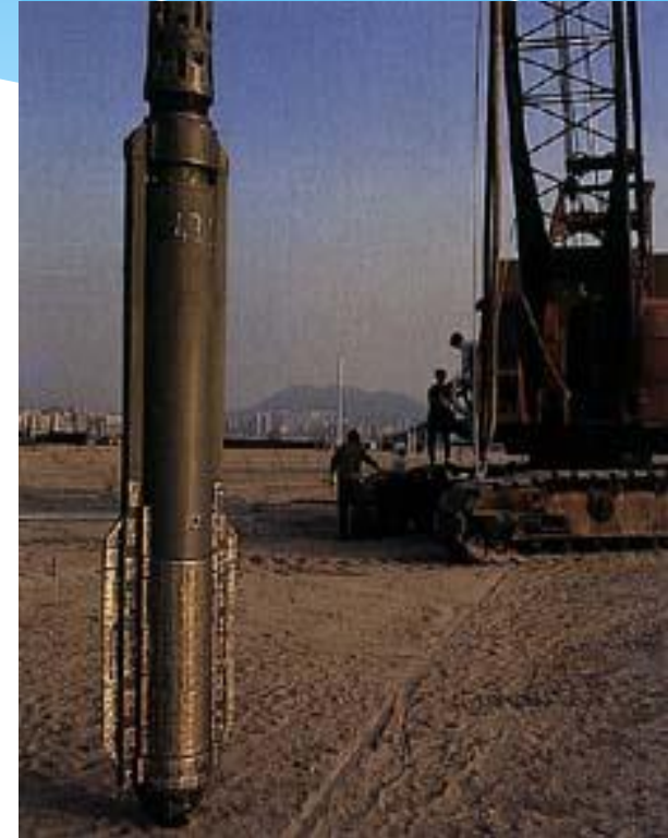
Şekil 13. Vibroflot aleti [V23 modeli Hong-Kong çapı: 35 cm ve ağırlığı: 2,2 ton] ( http://www.vibroflotation.com )
