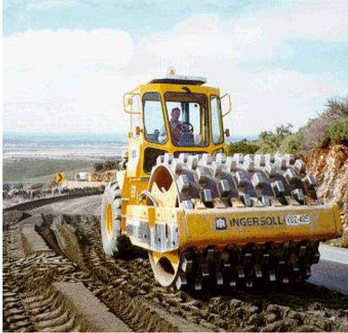
Şekil 7. Keçiyaklı silindir ( http://www.csstech.com )
