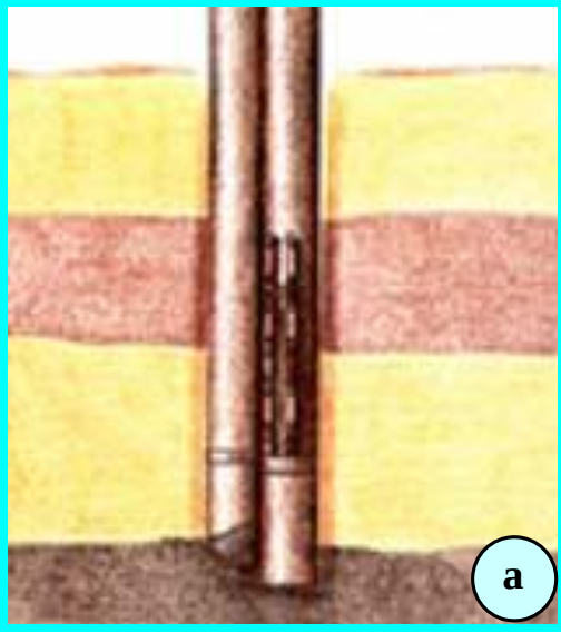
Şekil 15. Taş (granüler) kolonun oluşturulması ( www.vibroflotation.com )
