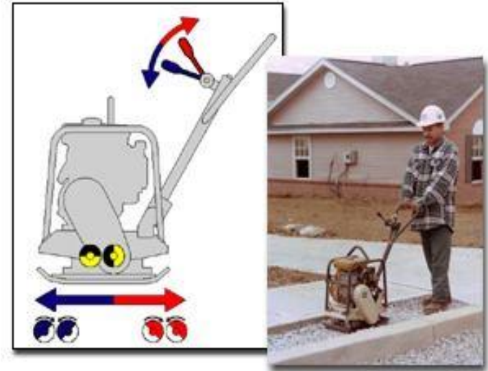
Şekil 10. Titreşimli plaka ( www.road-development.irco.com )
