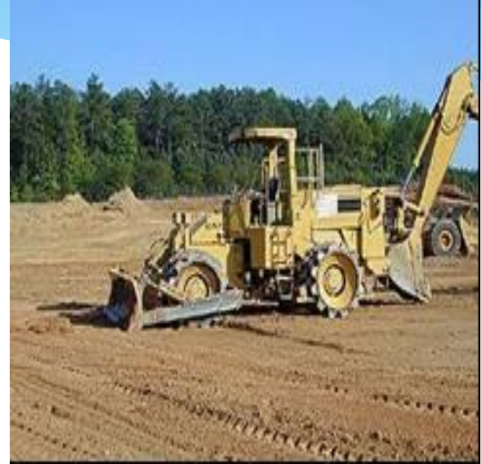
Şekil 8. Darbeli ayaklı (kendinden çekmeli titreşimli) silindir ( http://mypage.bluewin.ch )
