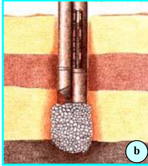
Şekil 15. Taş (granüler) kolonun oluşturulması ( www.vibroflotation.com )
