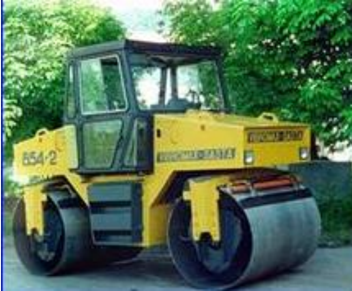
Şekil 5. Tambur silindir ( http://www.sasta.ru )
