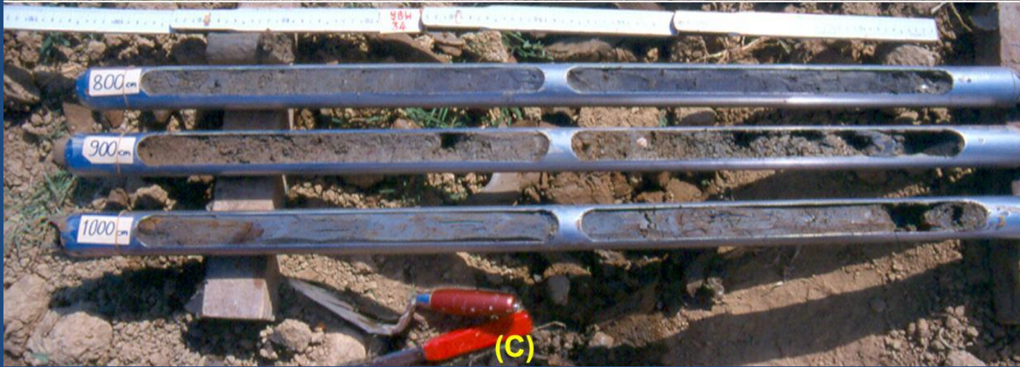
Foto 1A, B, C: Büyük Dere vadi tabanı (A) ve Tuz Gölü (B) çevresinde yapılan delgi sondaj çalışmaları ile sondajlardan elde edilen sediman örnekleri (C).
