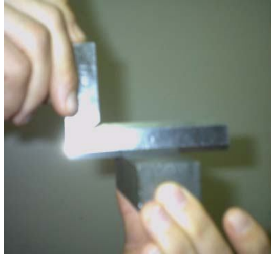
Kıl gönyesi ile yüzey kontrolü
