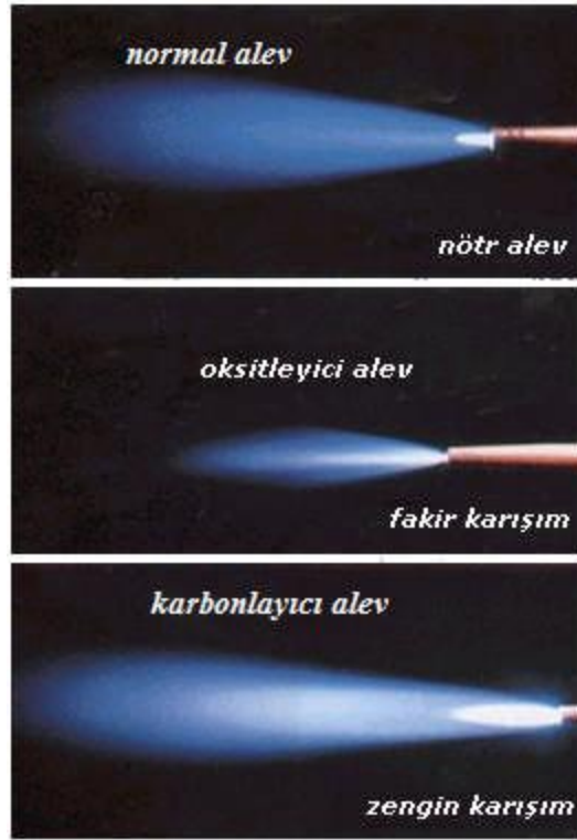
Resim 3.2: Oksi-gaz kaynağında alev yapısı
